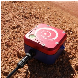
Figura 1: Dispositivo IoT de monitoramento microsísmico. Fonte: INVISION (2023)
