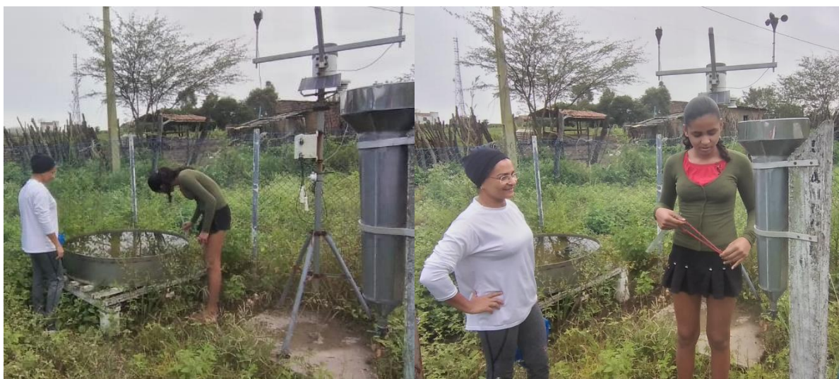
Figura 2- Realização da leitura do tanque classe A e de pluviômetro instalados na área experimental
