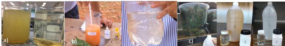
Figura 2: Antes e depois do tratamento. a) quiabo; b) mandacaru; c) bambu
