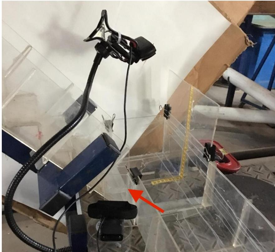
Figura 2 – Detalhe do ponto de medição da profundidade do escoamento no fim da descida
