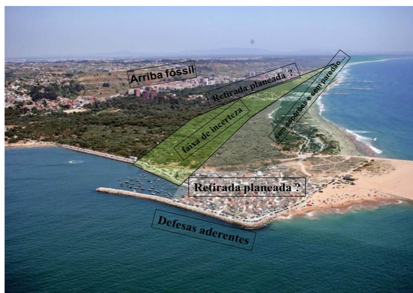
Figura 4. Indicação de uma faixa de incerteza associada ao “avanço” do mar se forem retiradas as estruturas de defesa costeira na praia da cidade da Costa da Caparica.
