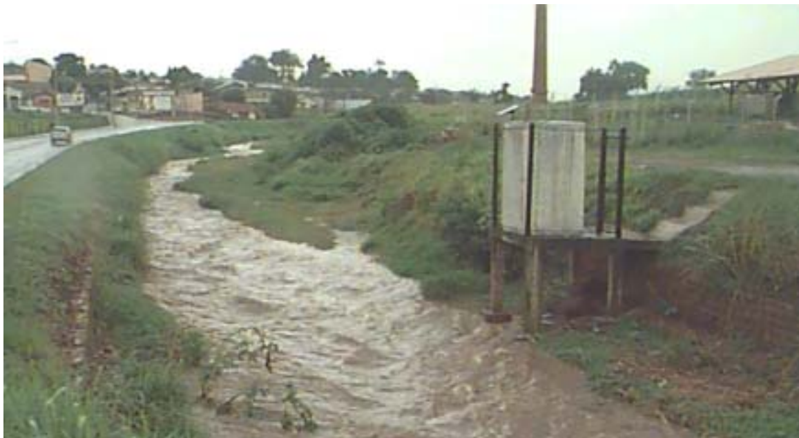
Figura 7: Estação 2 próxima ao Fórum Municipal equipada com sensores de chuva e nível d'água.
