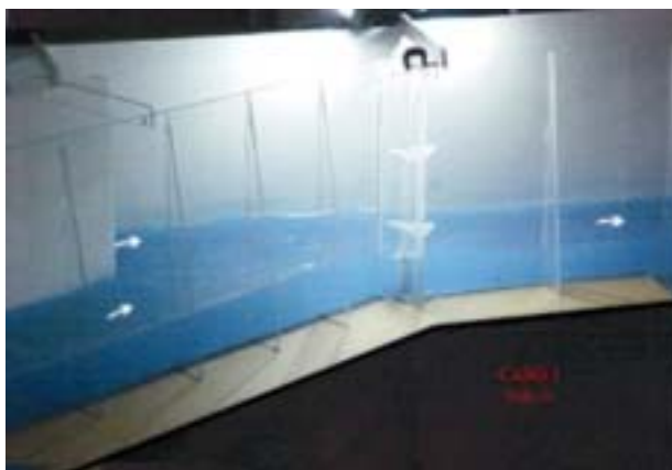
Figura 2 – Fotografia do modelo reduzido de confluência, construído no laboratório do CPH - EEUFMG.
