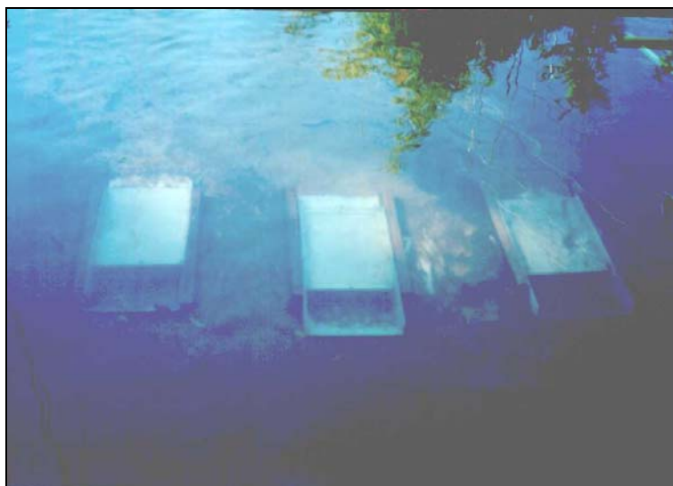
Figura 13 - Amostrador Waslenchuk em operação, na estação fluviométrica Sítio do Tio Pedro, Santa Maria/RS.
