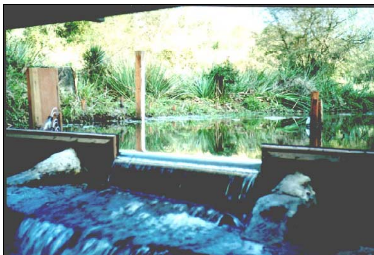
Figura 06 - Vertedor retangular composto vista de jusante, na estação fluviométrica Sítio do Tio Pedro, Santa Maria/RS.
