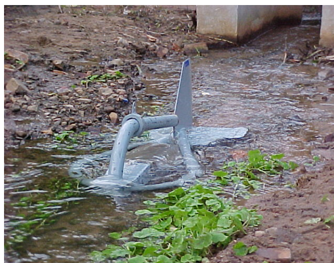
Figura 11 - Amostrador Helley-Smith em operação, na estação fluviométrica Sítio do Tio Pedro, Santa Maria/RS.
