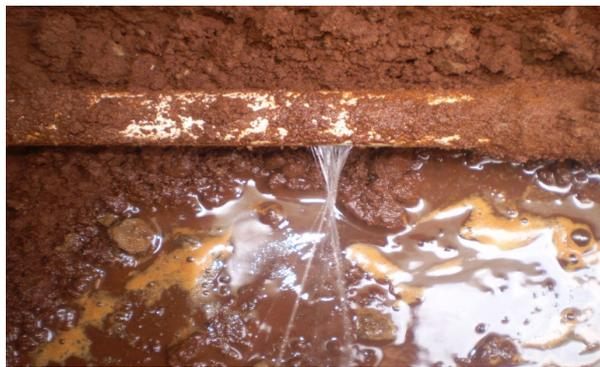
Figura 3 - Fratura encontrada em tubulação, em uma residência.
