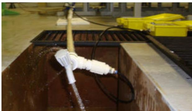
Figura 5 – Vazamento ocorrido na tubulação com defeito na rosca
