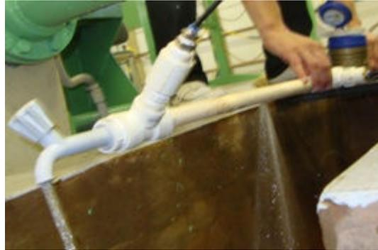
Figura 9 - Vazamento ocorrido na tubulação com orifício realizado em laboratório.
