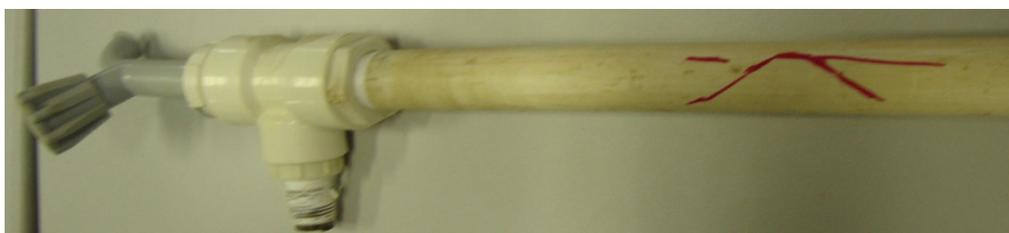
Figura 6 - Tubulação com fratura realizada em laboratório.
