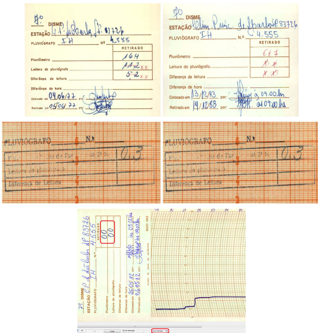
Figura 6 – Recortes de pluviogramas com inexistência ou falha nas alturas registradas nos pluviogramas pelo operador da Estação Climatológica.
