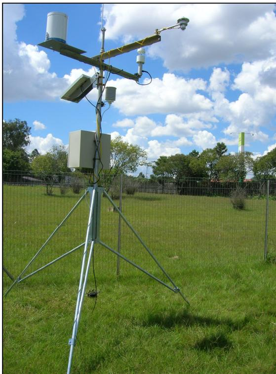
Figura 7 – Estação Meteorológica Automática Instalada
