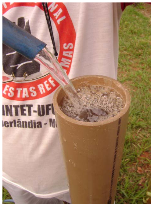
Figura 4 – Injeção de água no tubo para saturação do terreno.
