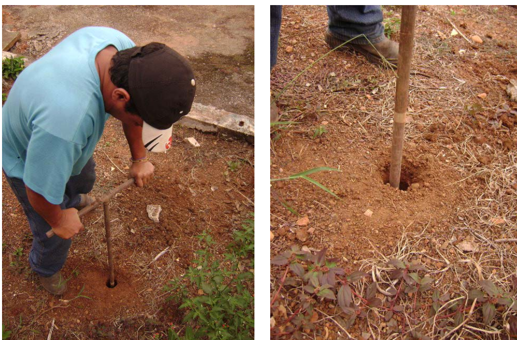
Figura 2 – Execução do furo de sondagem a trado manual.
