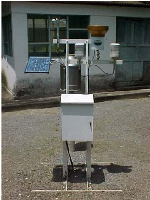
Figura 4 – Estação meteorológica automática instalada no pátio do DEN-UFPE, Recife-PE
