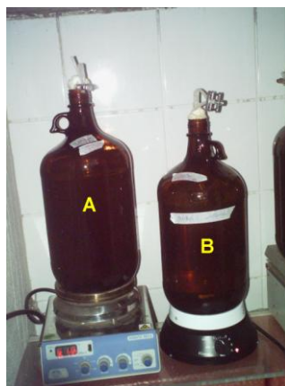
Figura 1- Tratamentos contendo o meio específico e atrazina, com destaque para galão inoculado com microrganismos (a) e sem inóculo de microrganismos (b).
