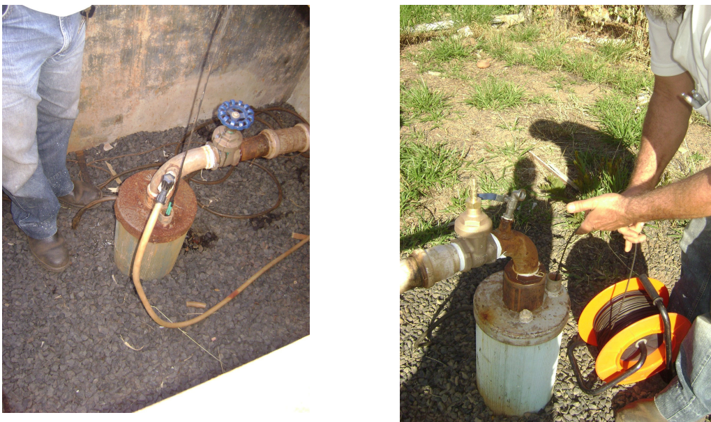
Figura 4 – Medição da profundidade do lençol nos poços de monitoramento.
