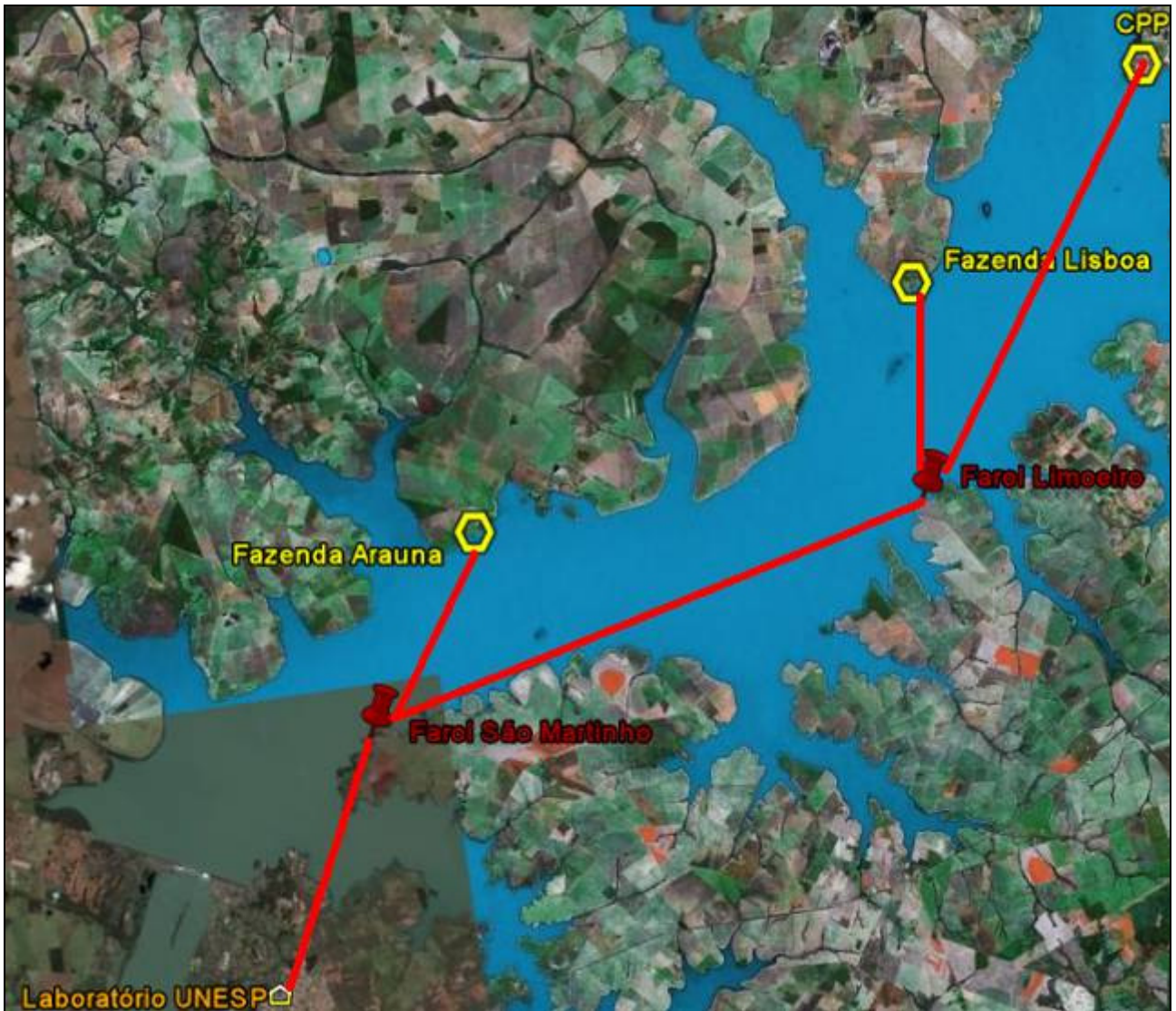
Figura 1 – Disposição dos pontos de medição e Base de recepção (UNESP)
