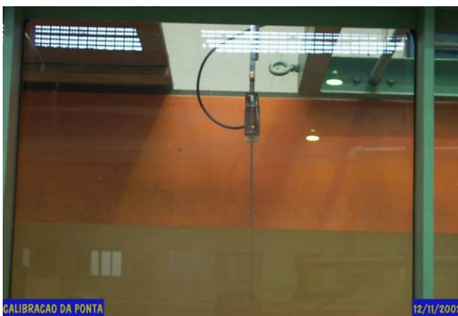
Figura 8.- Ponta capacitiva para medir a Variação do nível d'água no canal
