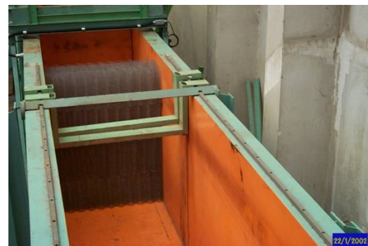
Figura 9.- Filtros metálicos dispostos à frente do gerador de ondas
