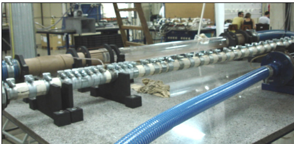
Figura 3: Bancada de testes preparada para início dos testes de perda de carga em condutos infestados pelo Limnoperna fortunei .
