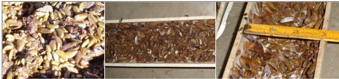
Figura 5: Detalhe de colônia de mexilhões em estado natural, comparada com a infestação artificial realizada em laboratório, a uma densidade de 1,0 indivíduo/cm 2 .
