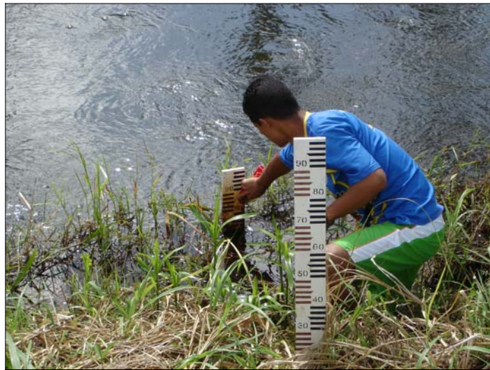
Figura 3. Leitura da régua limnimétrica instalada no rio Saúde realizada por um dos autores, Luiz Henrique, em 12 de outubro de 2005.
