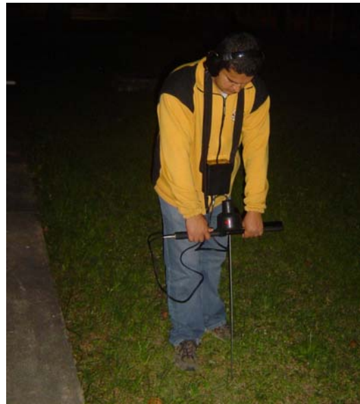
Figura 7 – Inspeção Noturna de Vazamento na UNIFEI (2006).
