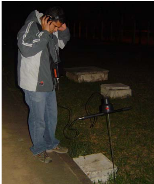
Figura 7 – Inspeção Noturna de Vazamento na UNIFEI (2006).
