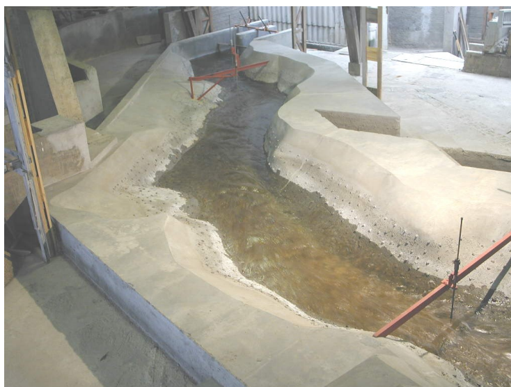
Figura 2 – Modelo físico do rio Paute – vista do trecho a jusante do eixo da barragem.
