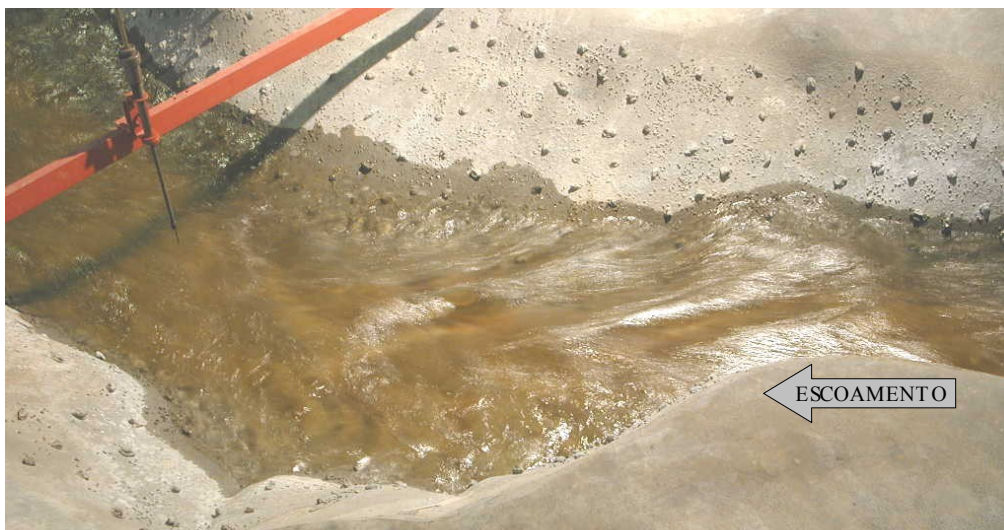
Figura 13 – escoamento na região da régua RL-2 no ensaio com vazão de 4.500 m 3 /s.
