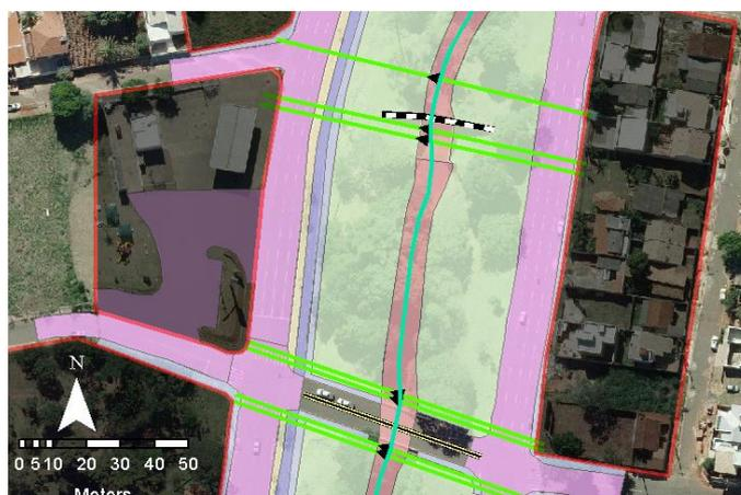
Nas simulações no HEC-RAS de uma maneira geral, o núcleo para as computações são as seções transversais, que foram obtidas dos órgãos oficiais da cidade, e combinadas com as que foram extraídas do modelo digital de elevação (MDE).
