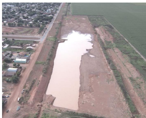
Figura 2- Bacia de detenção do município. Fonte: Prefeitura de Campo Novo do Parecis
