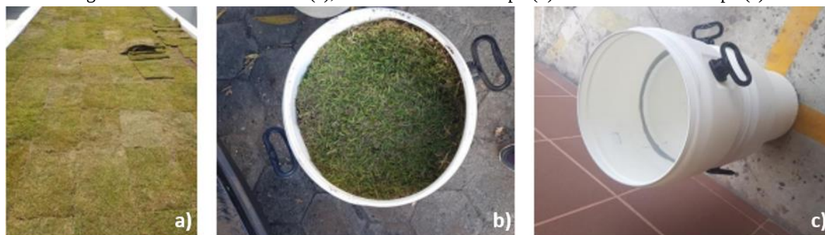
Figura 5 – Telhado Verde Real (a), Telhado Verde Protótipo (b) e Pluviômetro Protótipo (c).
