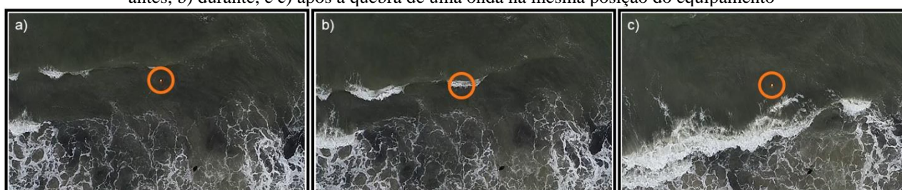
Figura 3 - Quadros de imagem de drone indicando ausência de transporte do derivador devido quebra de ondas: a) antes, b) durante, e c) após a quebra de uma onda na mesma posição do equipamento
