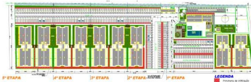
Figura 3 – Drenagem Compensatória – Proposta B
