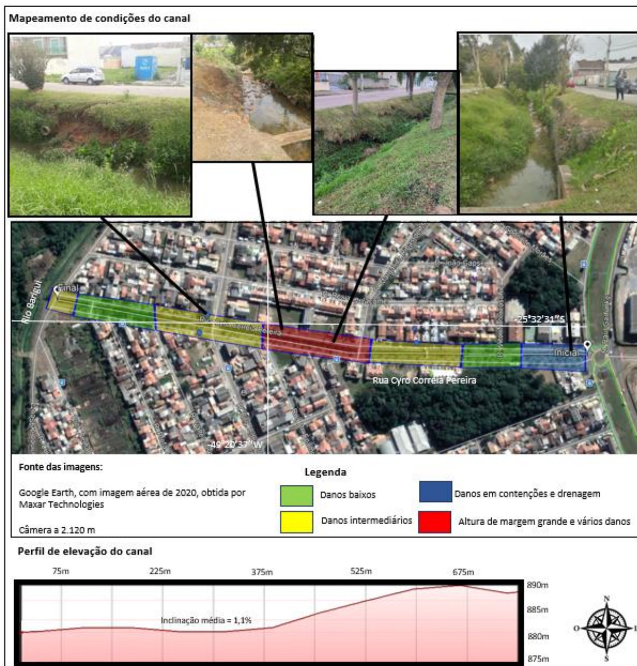
Figura 4 – Mapeamento dos sinais dos processos erosivos que estão ocorrendo no canal de drenagem em estudo. Fonte: Os autores, 2020
