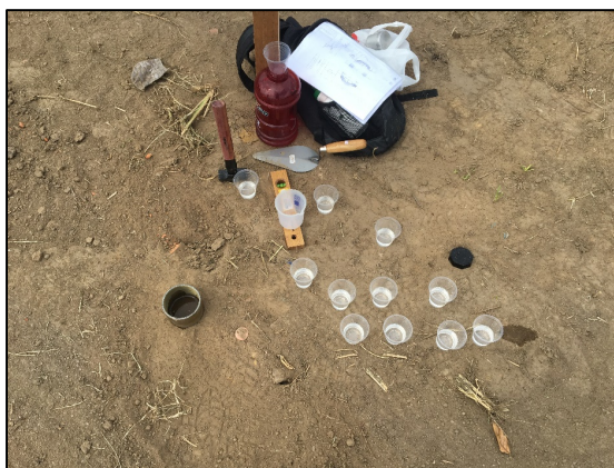
Figura 3 – Realização do ensaio de infiltração de campo
