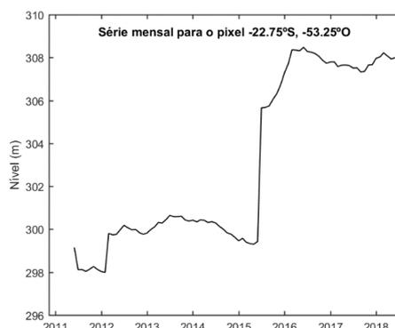
Figura 5 - Exemplo de resultado inconsistente obtido na interpolação, indicando que, provavelmente, os poços estão em formações geológicas distintas
