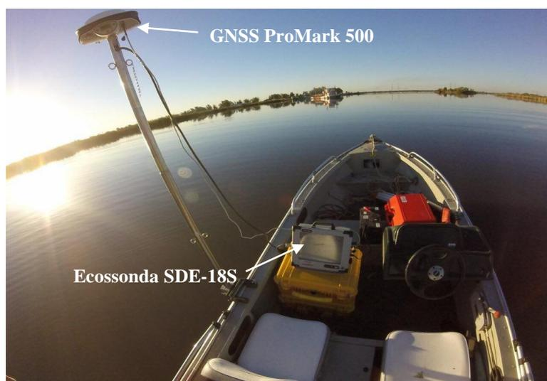
Figura 4 – Equipamentos utilizados para realizar a batimetria.
