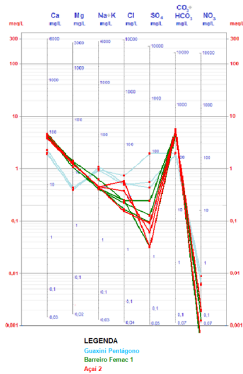
Figura 4 – Diagrama de Schoeller. Período seco. 1ª, 3ª e 4ª amostragens. Dezembro de 2016; 2017 e 2018. Salinópolis. O \text{Ca}^{2+} e o \text{CO}_3 + \text{HCO}_3^- estão enriquecidos e o \text{NO}_3^- quase sem presença na amostragem. Na 4ª campanha de amostragem houve acréscimo do valor do \text{SO}_4^{2-} no poço Guaxini Pentágono que superou todas as outras amostragens.
