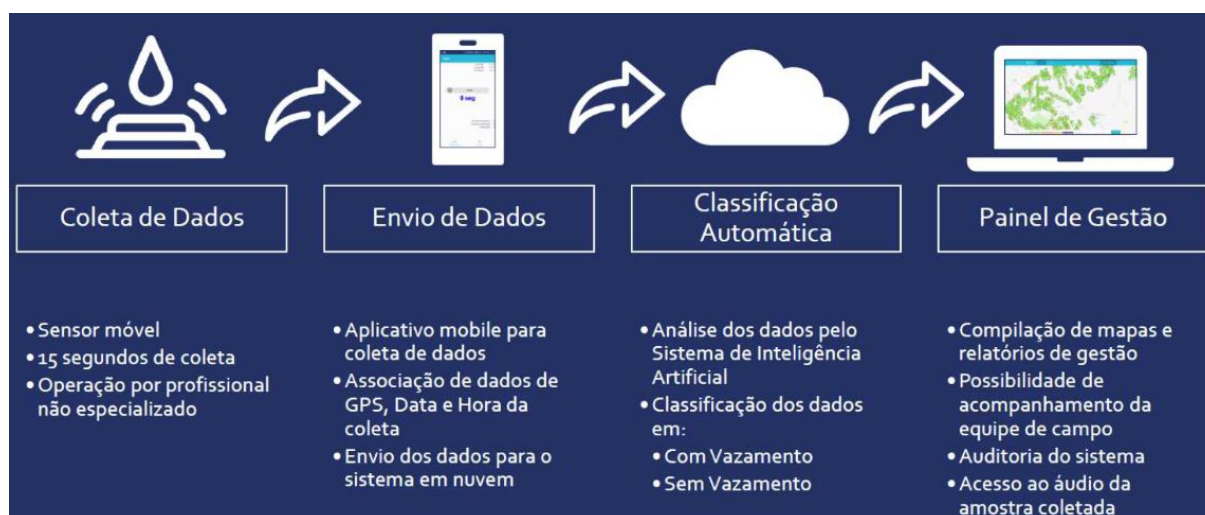
Figura 2: Fluxograma da coleta e classificação das amostras de ruídos de vazamentos. (Fonte: CAESB, 2019).
