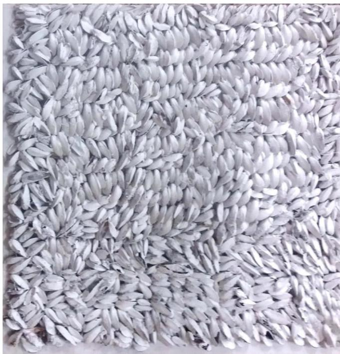
Figura 1 – Placa cerâmica incrustada artificialmente com MD.
