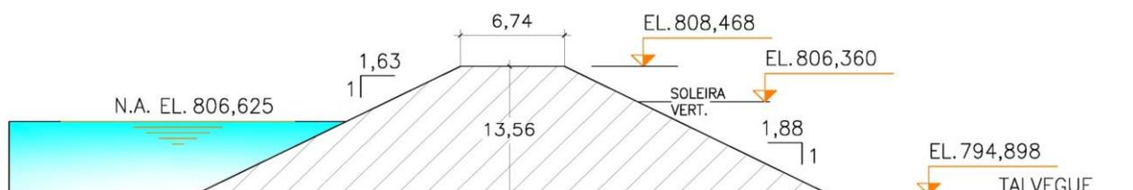
Figura 7: Esquema da seção transversal da barragem
