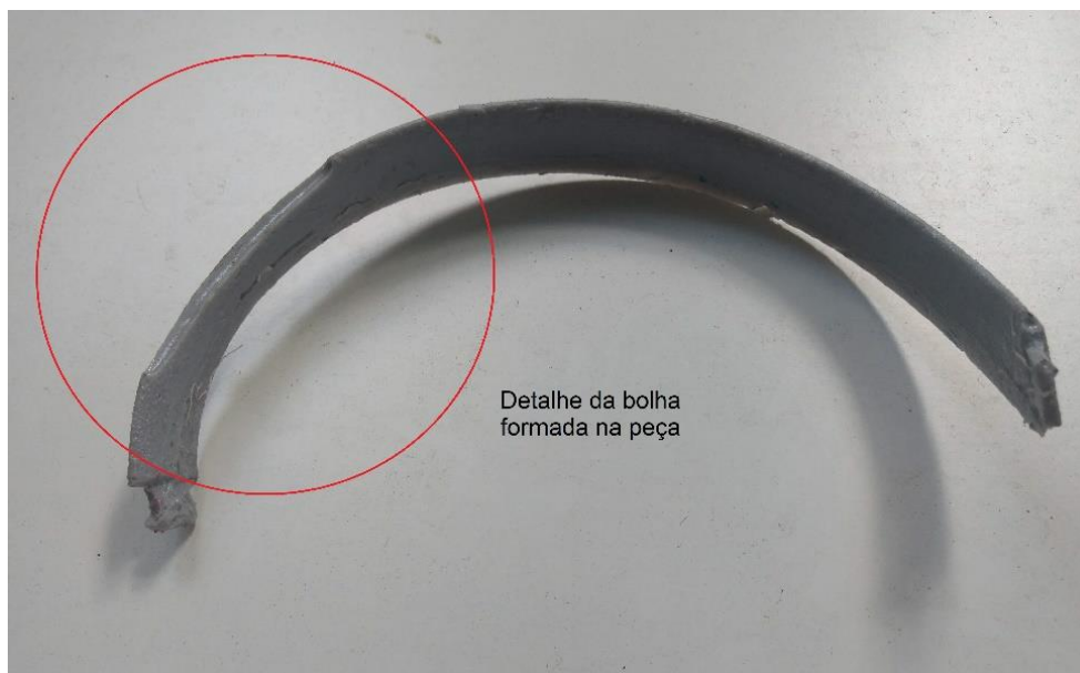
Figura 6: Detalhe do defeito na peça 1
