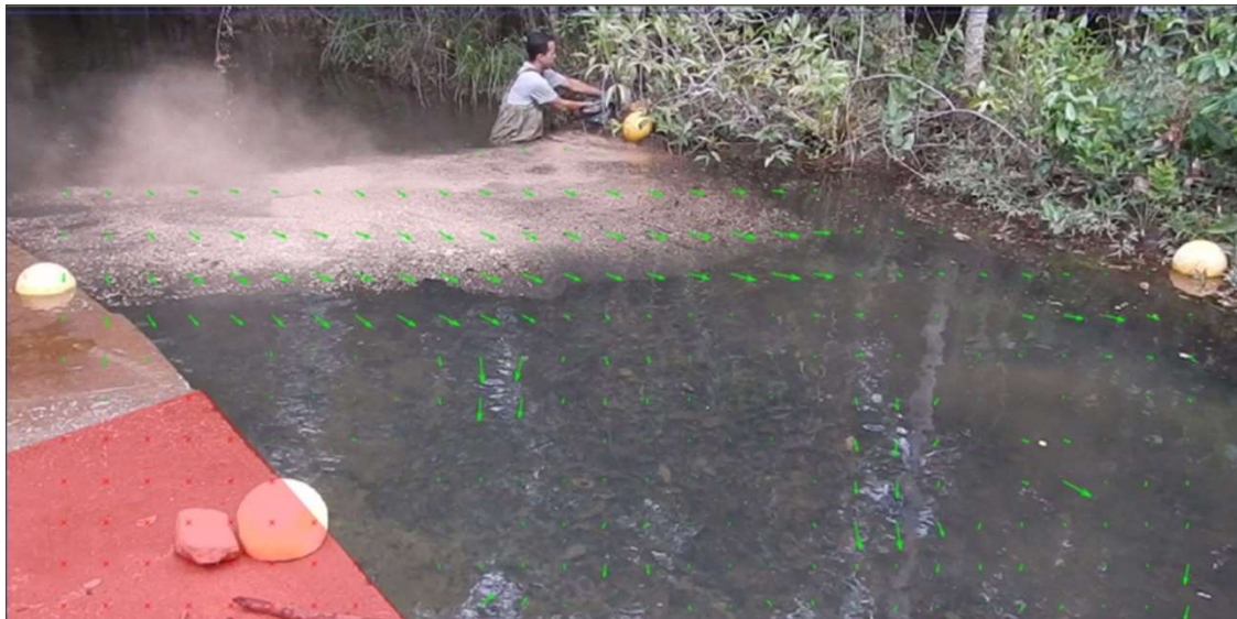
Figura 2: Utilização de folhas secas para visualização do campo de velocidades do fluxo.
