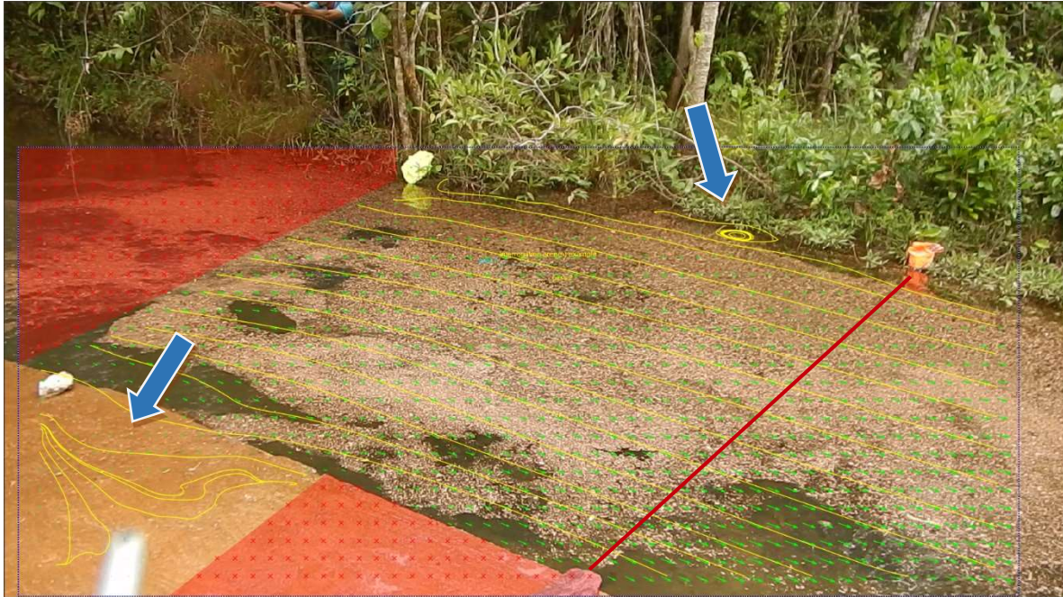
Figura 7: Campo de velocidade e linhas de fluxo da superfície do Rio Banana. Seção de medição em vermelho
