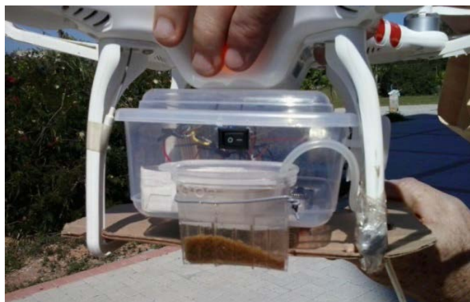
Figura 15 – Recipiente de acrílico preenchido parcialmente com água coletada pelo protótipo1 durante o voo em um lago artificial. Notar que no interior do recipiente também há lodo / sedimentos que foram bombeados do fundo do lago. Fonte: acervo do projeto.
