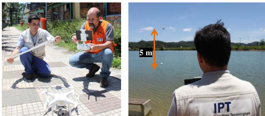
Figuras 13 e 14 – Preparação do protótipo 2 com drone, câmera, bailer , flutuador, rádio e tablet (à esquerda) e o teste preliminar feito ainda com contato visual direto (à direita) 6 . Fonte: acervo do projeto.
