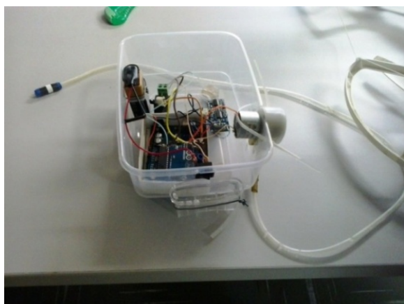
Figuras 7 e 8 – Componentes eletrônicos e recipiente para armazenamento da amostra embarcados na vasilha plástica (à esquerda) e a versão final do protótipo 1 (à direita). Fonte: acervo do projeto.
