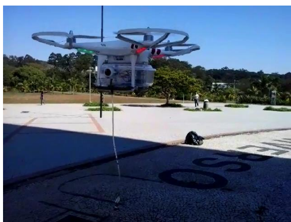
Figuras 9 e 10 – Protótipo 1 em pleno voo (à esquerda) e coletando amostra de água em um lago artificial. Fonte: acervo do projeto.
