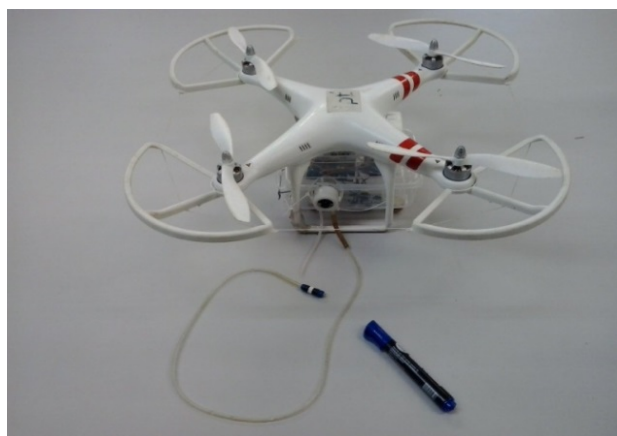
Figuras 7 e 8 – Componentes eletrônicos e recipiente para armazenamento da amostra embarcados na vasilha plástica (à esquerda) e a versão final do protótipo 1 (à direita). Fonte: acervo do projeto.
