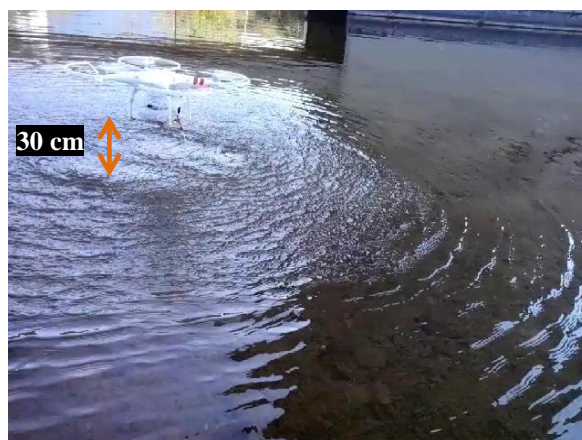
Figuras 9 e 10 – Protótipo 1 em pleno voo (à esquerda) e coletando amostra de água em um lago artificial. Fonte: acervo do projeto.
